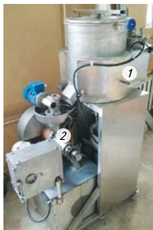
Рис. 1. Лабораторная установка для производства экструдированных комбикормов для ценных видов рыб:
