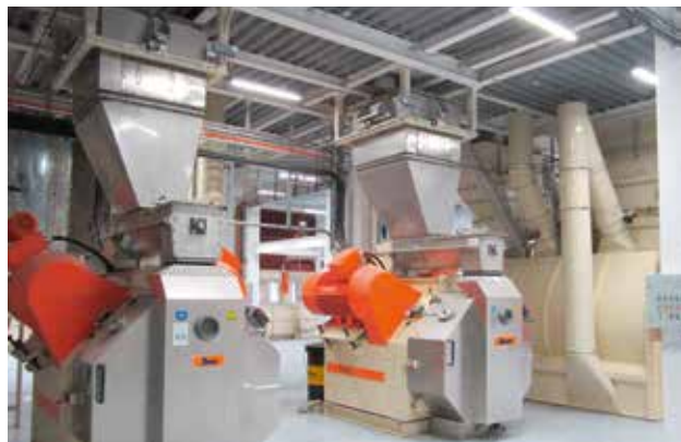
Пресс-грануляторы 2 x 20 т/ч | Pelleting press 2 x 20 t/h
