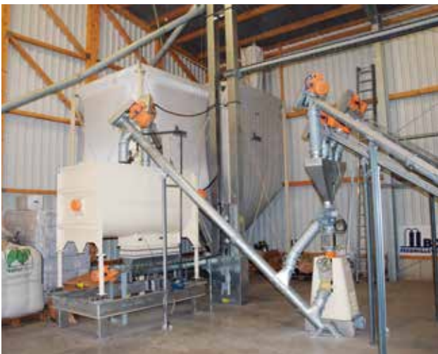
Комбикормовый цех производства корма для кур-несушек 2 т/ч, Биберталь, Германия | Production of layer feed 2 t/h in Biebertal, Germany
