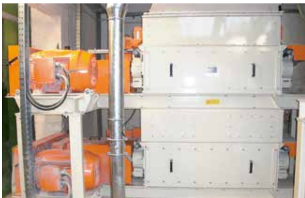
Вальцовый станок двухпарный 2 x 35 т/ч | Double roller mills 2 x 35 t/h
