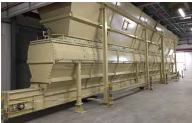
Дозирующие весы с подвесным бункером Batch scale with hopper
