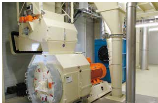
Молотковая дробилка 250 кВт с аспирационной установкой Hammer mill 250 kW with filter system
